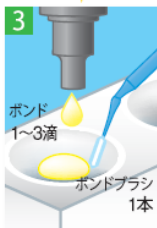
3 ボンド 1〜3滴 ボンドブラシ 1本 必ずボンドブラシ でボンドを混合 ※混合後、1分以内に使用
