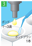
ボンド 1～3滴 ボンドブラシ 1本 ボンドブラシで ボンドを混合 ※混合後、1分以内に使用
